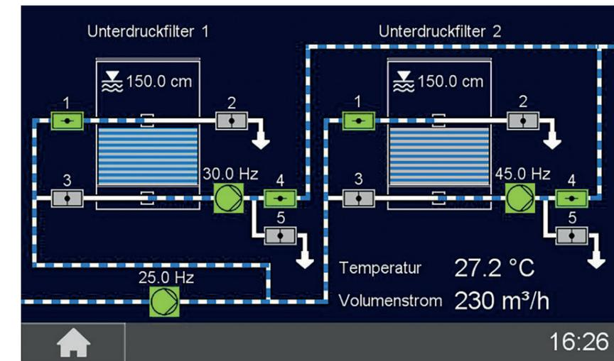
Digitale Prozessvisualisierung auf dem Touchscreen des Steuercomputers mit Fließschema, Klappenstellung und Anzeige von Volumenstrom und Wasserniveau im Filter
